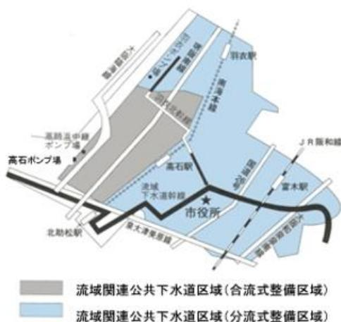
高石市の下水道の排除方式は、汚水（トイレ・台所・風呂などの排水）と雨水を同じ下水道管で排水する合流式、汚水と雨水を別々に排水する分流式があります。
